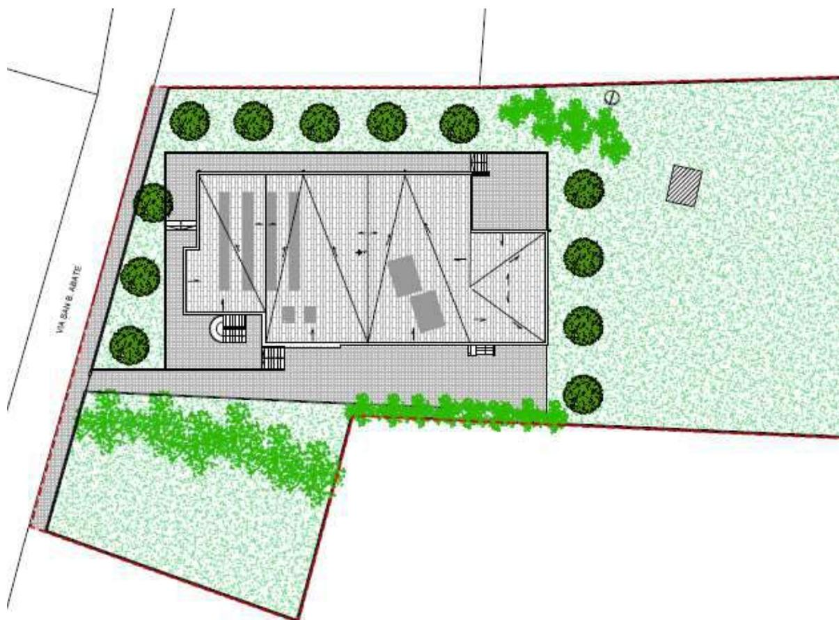
L'intervento prevede la realizzazione di una struttura, adibita ad ospitare un massimo di 45 utenti. Il nuovo edificio sarà orientato lungo l'asse nord-sud, allineandosi al fronte occidentale della via San Barsanofio Abate, traversa di via Frascati, in adiacenza all'edificio che già ospita i suddetti servizi pubblici, principalmente sanitari.
